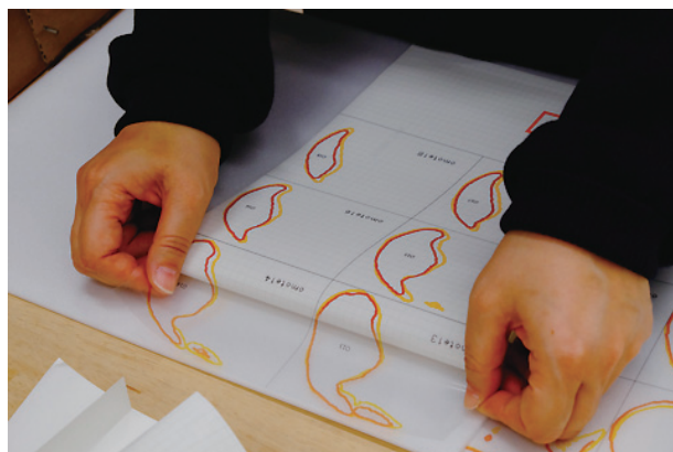
図5 スチレンボードへの透明シート貼付けの様子
