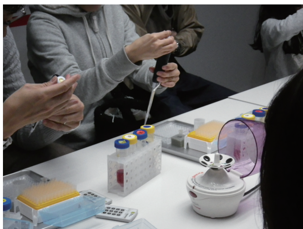
写真1 マイクロピペットの容量を調節しているところ。
